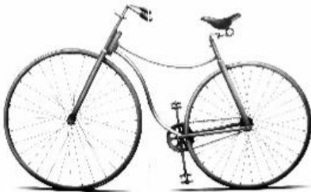
Die Räder wurden mit einer Luftbereifung versehen. Dadurch verminderten sich Erschütterungen und Fahrgeräusche beträchtlich. Bis anhin wurden die Fahrräder mit den Füßen gebremst. Die Erfindung der Rücktrittbremse brachte um 1900 viel mehr Sicherheit. Der Einbau einer Gangschaltung ermöglichte zudem, den Antrieb an unterschiedliche Belastungen anzupassen.
