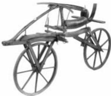
Der deutsche Forstbeamte Drais tüftelte am Lauftrad weiter und verbesserte es mit einer Lenkung. Dieses Holzgefährt trieb er mit den Füßen an und erreichte damit bis zu 15 km/h. Dies war zu der Zeit immerhin schneller als die Postkutsche! Die Draisine ist die Urform des Fahrrades.
