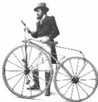
Um Fußverletzungen zu vermeiden, wird das Vorderrad mit Tretkurbeln versehen und damit das Rad unmittelbar angetrieben. Die Holzräder hatten einen Reifen aus Metall und liessen den Fahrer jede Unebenheit spüren. Darum wurde das Veloziped auch Knochenrüttler genannt.
